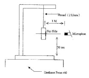
1 METER FROM MICROPHONE TO FAN INTAKE
