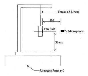
1 METER FROM MICROPHONE TO FAN INTAKE
